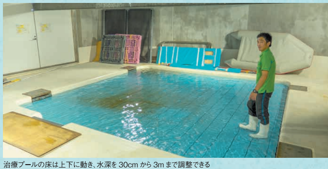
治療プールの床は上下に動き、水深を30cmから3mまで調整できる
