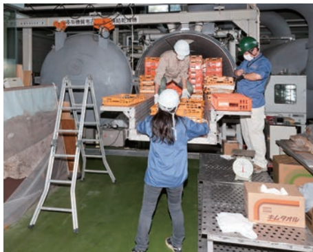
大型真空凍結乾燥機を用いた水損した紙資料の乾燥処理 提供：奈良文化財研究所
